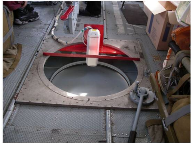
Рис. 2. ТВ камера, установленная в грузовом люке
